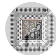
Évaluation PlanarCT avancée (gauche) sans superposition dans l'image radiographique
